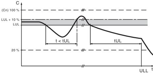
Определение недогрузки двигателя (ULL)
