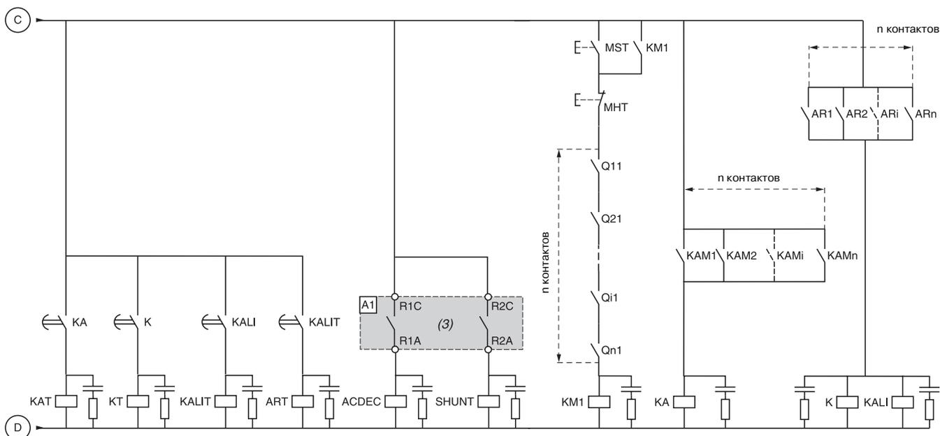
(3) Назначьте реле R1 в качестве "реле изолирования". Обратите внимание на ограничения по использованию контактов (см. характеристики на стр. 4), применяйте промежуточные реле для более мощных контакторов.
